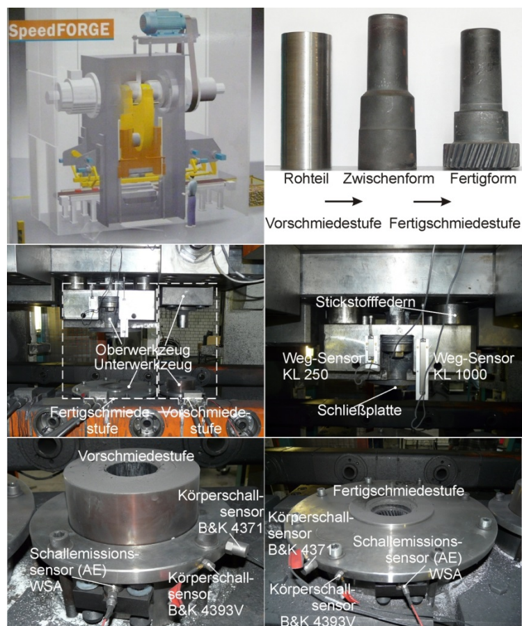
Abb. 6: Kurbelpresse mit zweistufigem Werkzeugsystem und angebrachter Zusatzinstrumentierung [2]
