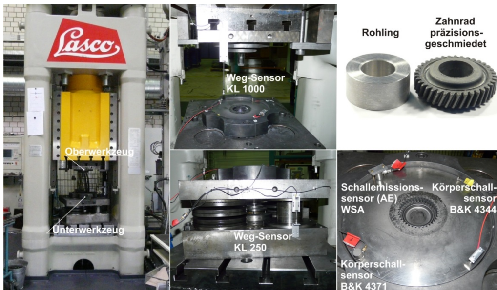
Abb. 2: Lasco Spindelpresse mit Werkzeugsystem für schrägverzahnte Zahnräder sowie Werkzeuginstrumentierung [1], [4]
