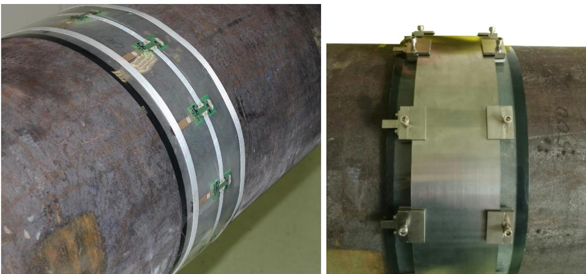
**Abbildung 8:** Am Rohr angelegte Sensormanschette; links ohne Befestigungsband, rechts mit Befestigungsband
