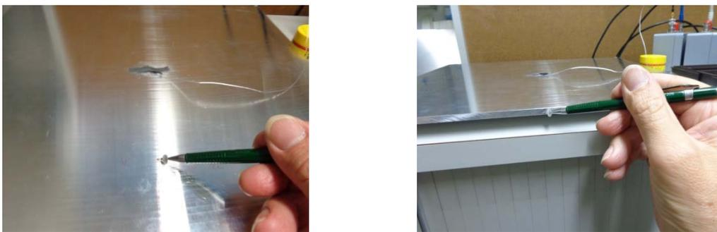
**Abb. 2.** Bleistiftminenbrüche auf einer Aluminiumplatte zwecks Vergleich simulierter mit gemessenen Signalen für die Miniatorsensoren des Typs M31 (links) Bleistiftminenbrüche auf der Aluminiumplatte, d.h. Auslenkung normal zur Plattenebene und (rechts) auf der Kante, d.h., Auslenkung in Plattenebene.
