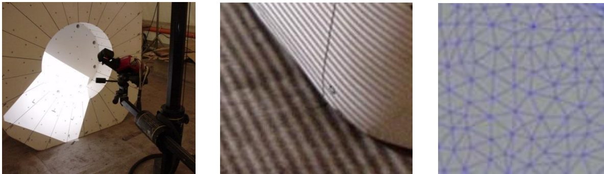
Abb. 1. Streifenprojektionssensor vor dem Messobjekt, Details des Projektionsmusters und vernetzter Oberflächenpunkte (von links)
