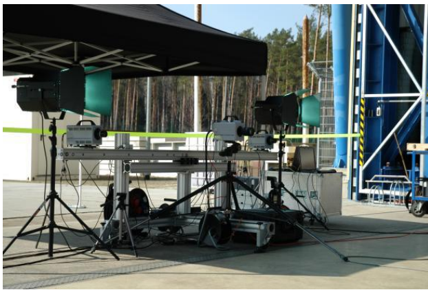
Abb. 5. Stereokameraanordnung im Kantenfalltest
