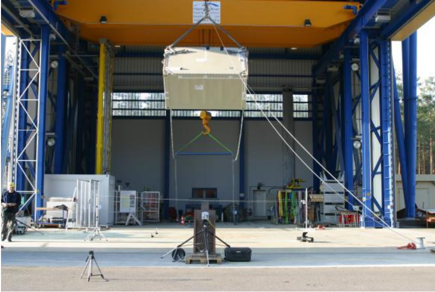
Abb. 2. Stahlblechcontainer vor dem Kantenfall aus 5 m Fallhöhe
