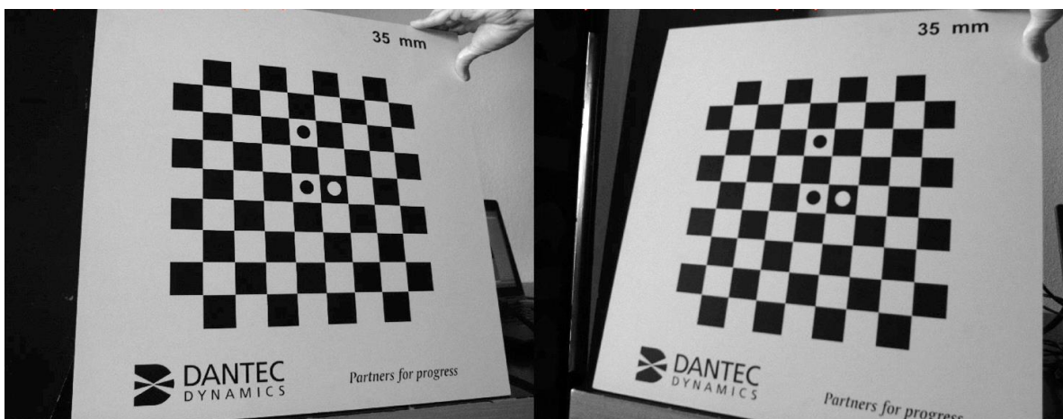
Abb. 3. Stereoaufnahme einer Kalibrierplatte für die vollautomatische Systemkalibrierung.
