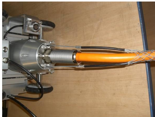
Abb. 4. Spezialkabel mit robuster Steckverbindung
