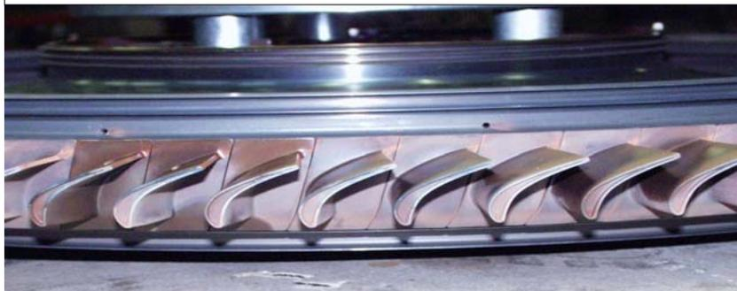
Das Gas- Luftgemisch am Ausgang der Brennkammer besitzt zwei Energieformen, Wärme- und Druckenergie die in mechanische Energie (Rotationsenergie) umgewandelt wird
