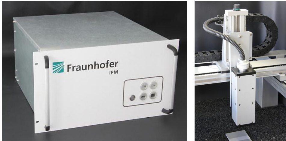
Abb. 1 Kompaktes THz-System optimiert für den industriellen Einsatz.
