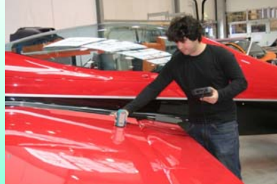
FSC1/7: Lackdickenmessung an einem Aerobatic-Kleinflugzeug (XtremeAir)
