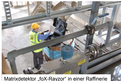
Matrixdetektor „foX-Rayzor“ in einer Raffinerie
