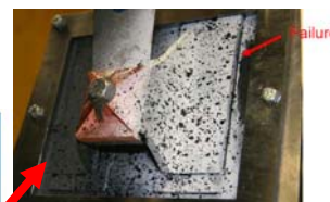
Versagen der Fügefläche
