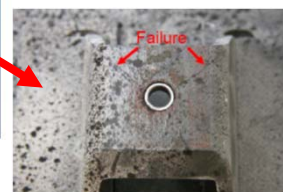
Versagen im CMC-Gefüge
