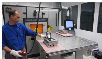
Prüfteil auf Palette positionieren
