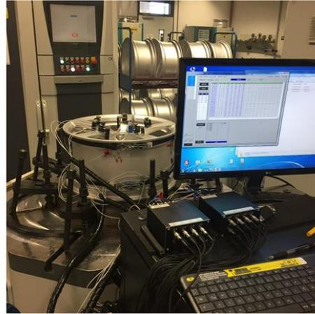
**Abb. 3.** Messaufbau für die AT-Sensorik während der BUP von Aluminium-Schmiederädern mit breiten Speichen
