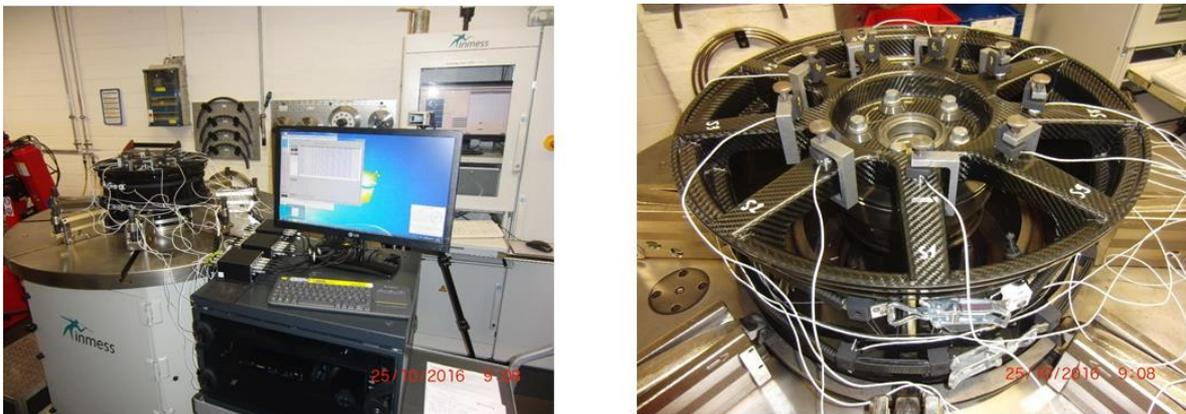
**Abb. 9.** Messaufbau AT während der BUP eines Komposit-Rads mit optimierten Winkel-Kopfstücken der Sensoren auf den Speichen und zwei Sensorgürteln im Felgenbett [5]
