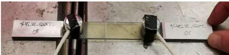
Abb. 3: Prüfkörper inkl. befestigter WD Sensoren
