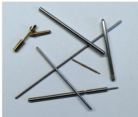
**Abb. 1.** Typische Miniaturdrehteile. Der längste Stab besitzt eine Länge von 100 mm.
