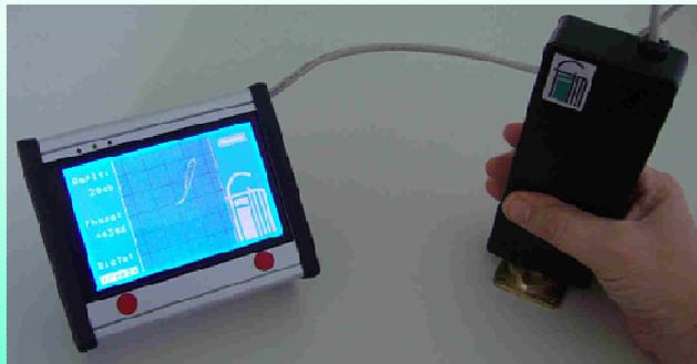
**Vorschaltgerät FVG:** spezielle Ausführungsform des FMH1 mit Anschluss an Wirbelstrompüfgerät.
