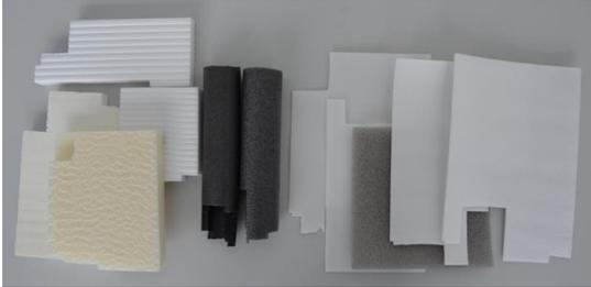
Geschäumte Rohre, Platten und Folien aus verschiedenen Materialien (PE, PET, PS, PP)
