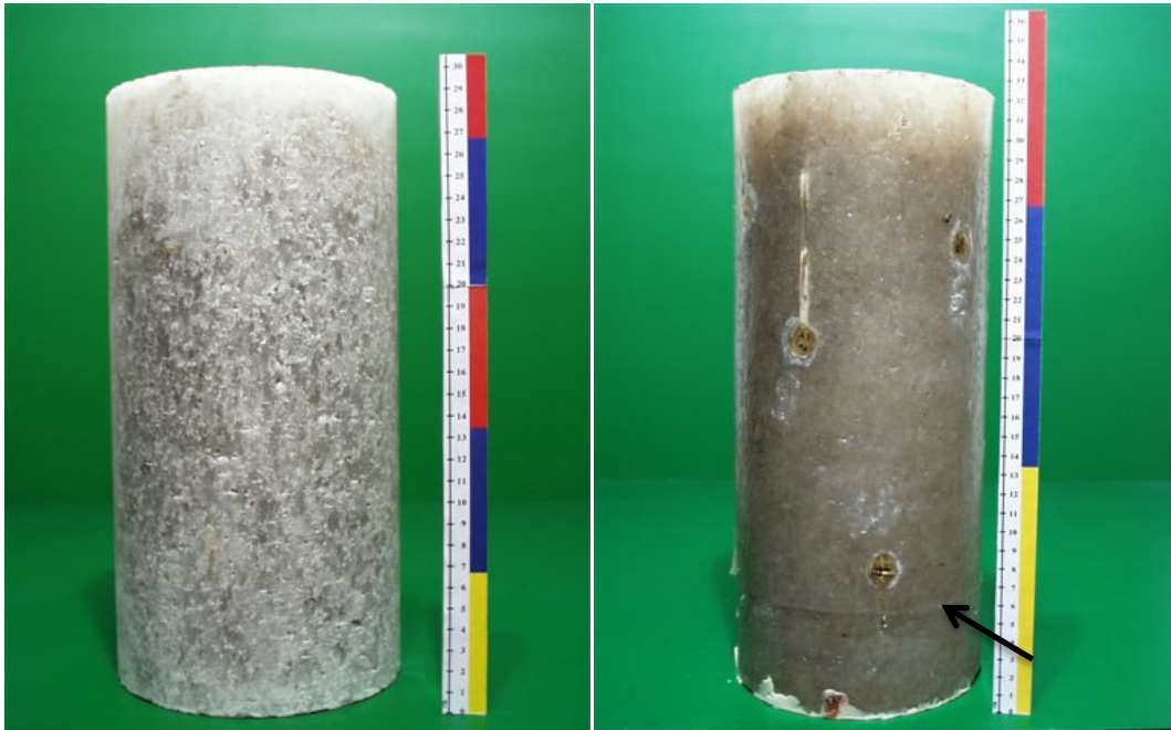
Abb. 7. Photographie der Steinsalzprobe vor (links) und nach dem Extensionsversuch (rechts). Der schwarze Pfeil in der rechten Teilabbildung markiert die makroskopische Bruchfläche an der die Probe versagte.
