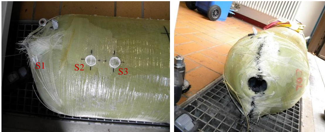
Abb. 7. Behälter C02 mit Versagen im Bereich des Anschlussadapters
