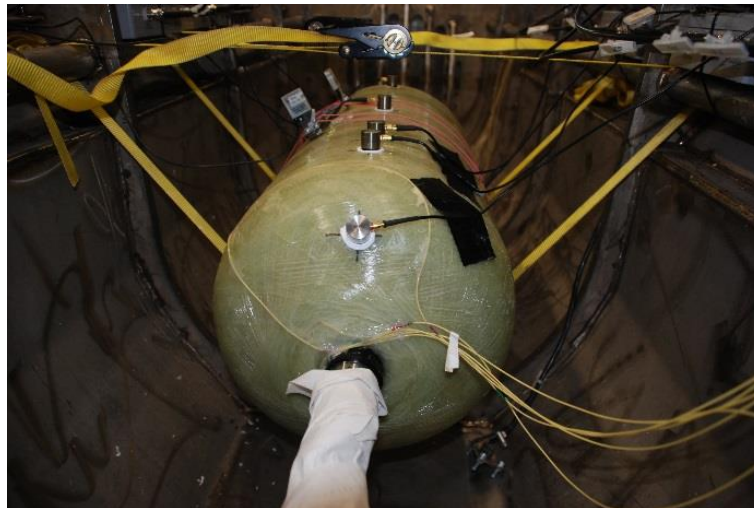
Abb. 2. Typ 4 – CfK-/GfK-Hybridbehälter mit faseroptischer Sensorik und Schallemissionssensoren
