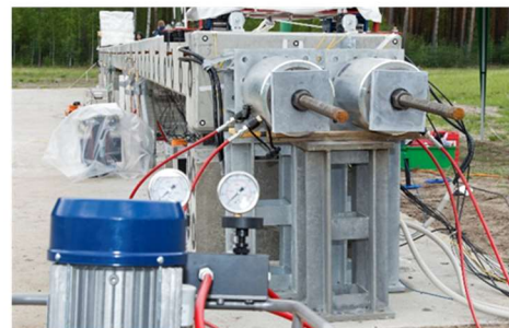
Abb. 2. Links: U-förmiger Querschnitt der Modellbrücke. Rechts: Hydraulisches System zur Änderung der Vorspannung.
