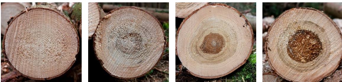
Bild 1. Schnittflächen von Fichtenstämmen mit Fäulegrad 0, 1, 2 und 3 (von links nach rechts)
