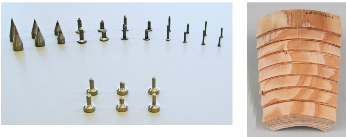
Bild 2. Ankoppelnägel für die Ultraschallwellen (links) und Stufentestkörper zur Bestimmung der Ultraschall-Systemlaufzeit (rechts)
