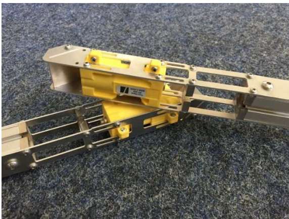
Abbildung 3: Prüfarme mit Winkel-spiegel für Test an Konstruktionsbohle
