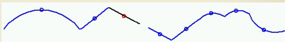
modellierte zusammengesetzte Reflektorfläche, Kreise markieren den Ort einzelner Teile
