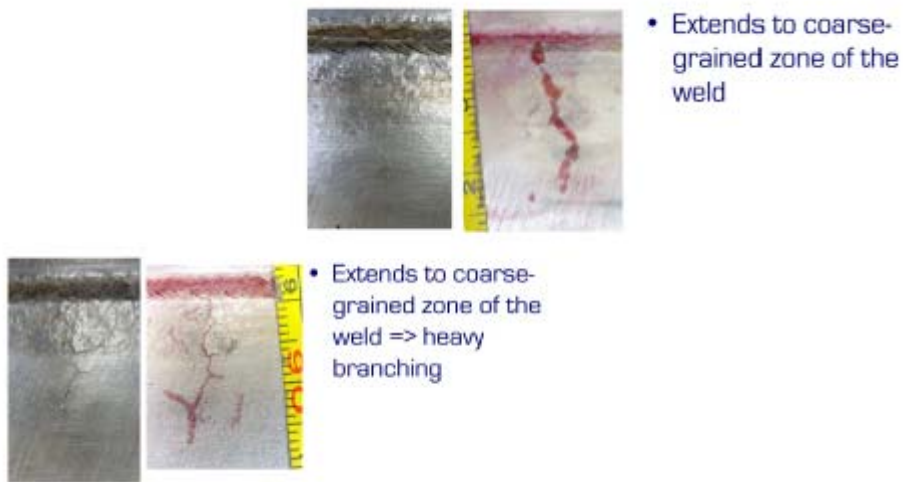
Bild 17: Fehleranzeigen im Testkörper
