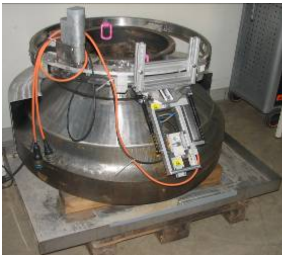
Bild 8: ein Robotiksystem neuester Art für Stutzenprüfungen
