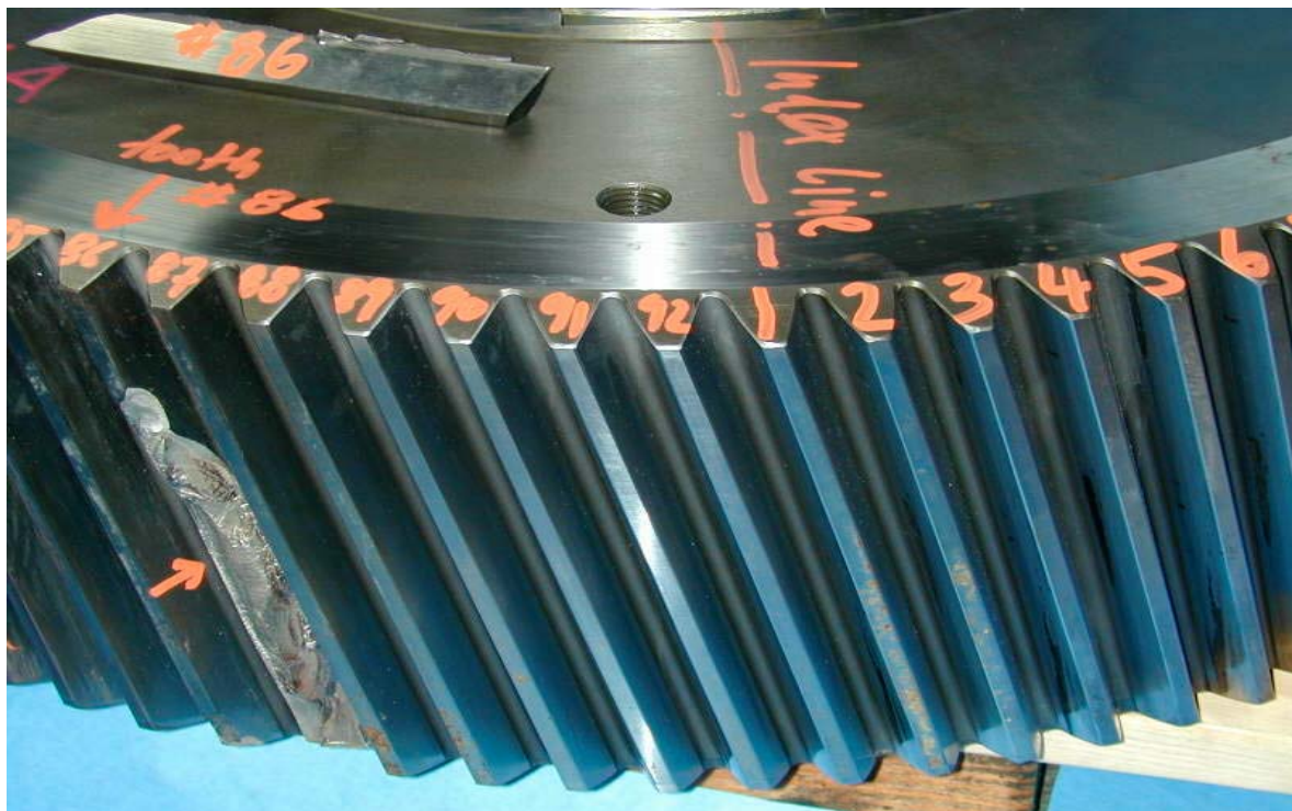
Bild 1: Materialschaden an Zahnrad
