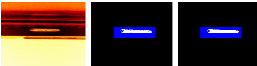
Abbildung 8: Differenz-Thermobild (links), Pixelklassifikation roh (mitte) bzw. konturgeglättet (rechts)
