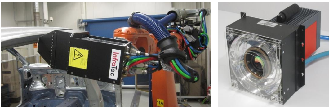
Abbildung 3: Dual-Thermografieprüfkopf, auf Roboter montiert (links) und geöffnet (rechts)
