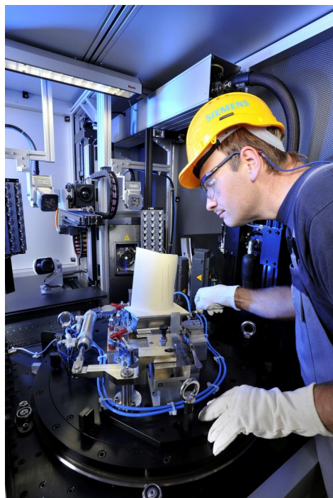
Abb. 3. Blick ins Innere des Prüfsystems: Im Vordergrund der Dreh-Schwenktisch, oben rechts der Heißluftschlauch, im Hintergrund die Kameras für den visuellen und Infrarotbereich, sowie Blitzanregung und Beleuchtung
