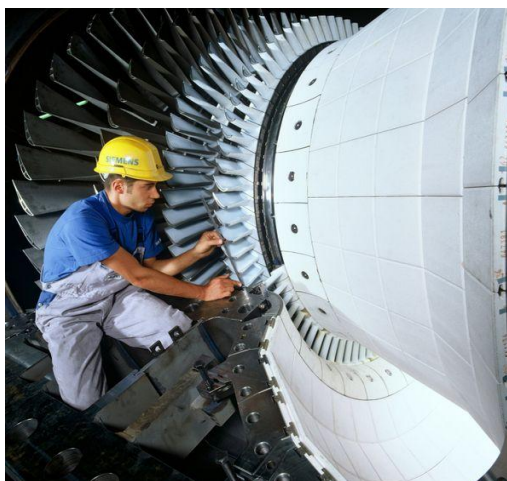
Abb. 1. Fertigung einer Gasturbine – gezeigt ist ein Ausschnitt der Brennkammer und die Laufschaufeln des Rotors
