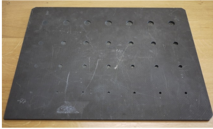
Abb. 8. Ebene CFK-Platte (Dicke 6 mm) mit Flachbodenbohrungen in unterschiedlichen Tiefen.
