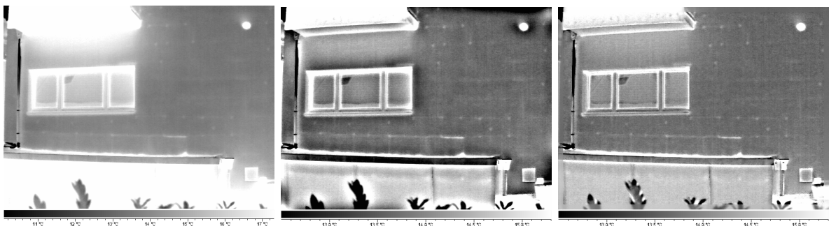
Abb. 8: Links: Rohes Thermogramm eines WDVS bei abendlicher Abkühlung. Die im Beton von Balkonen und Brüstungen gespeicherte Tageswärme überstrahlt viele Teile des Bildes. Mitte: Wenn man einen Hintergrund mittels eines Fourier-Tiefpassfilters berechnet und mit 80% abzieht, werden viele Details sichtbar, aber es verbleiben Überschwinger und Artefakte. Rechts: Erst die Verwendung eines Kanten erhaltenden Medianfilters, ebenfalls mit 80% Wirkung macht die feinen, hier gesuchten Details überall störungsarm sichtbar.
