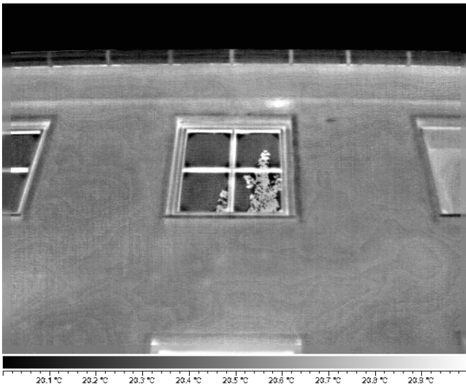
Abb. 12: Das Verfahren hat seine Grenzen in der digitalen Auflösung des AD-Wandlers des Sensors. Hier wurden 20 Einzelaufnahmen zuerst einander überlagert und gemittelt und dann erst das Gesamtergebnat eingeebnet. Die begrenzte digitale Auflösung des AD-Wandlers zeigt sich hier in Form von unschönen „Zwiebelringmustern“.
