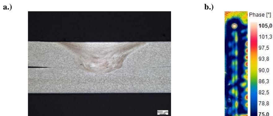
Abb. 2: i.O.-Naht einer Überlappverbindung: a.) Schliffbild und b.) Phasenbild nach thermografischer Prüfung
