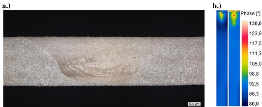
Abb. 4. Referenzmessungen an Stumpfstößen mit optimierten Schweißparametern ohne Prozessbeeinflussung
