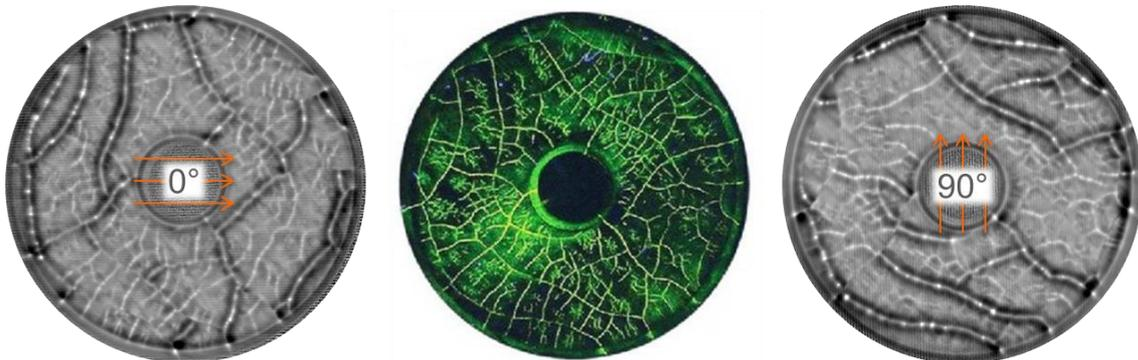
**Abb. 6:** Ergebnis der Prüfung mit Induktions-Rissthermografie am Vergleichskörper 1 (DIN EN ISO 9934-2)
