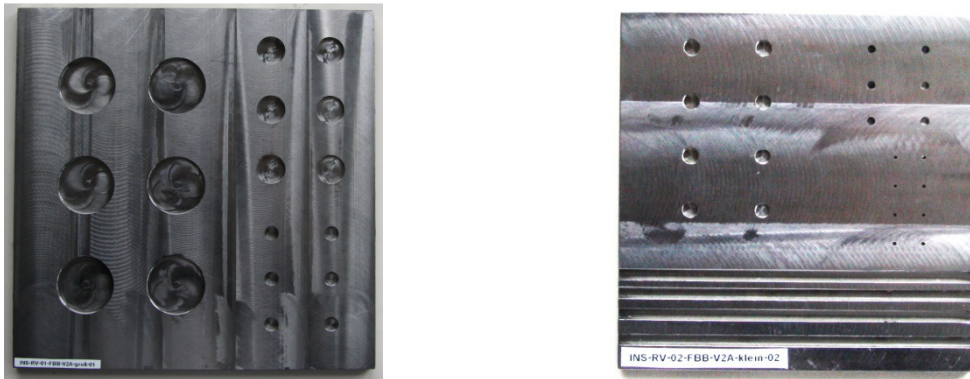
Abb. 1. Rückseiten der V2A-Probekörper mit äußeren Abmessungen von 200 x 200 x 7,5 mm 3 (links) und mit 100x100x4,5 mm 3 (rechts) mit Flachbodenbohrungen verschiedener Durchmesser und Tiefen.
