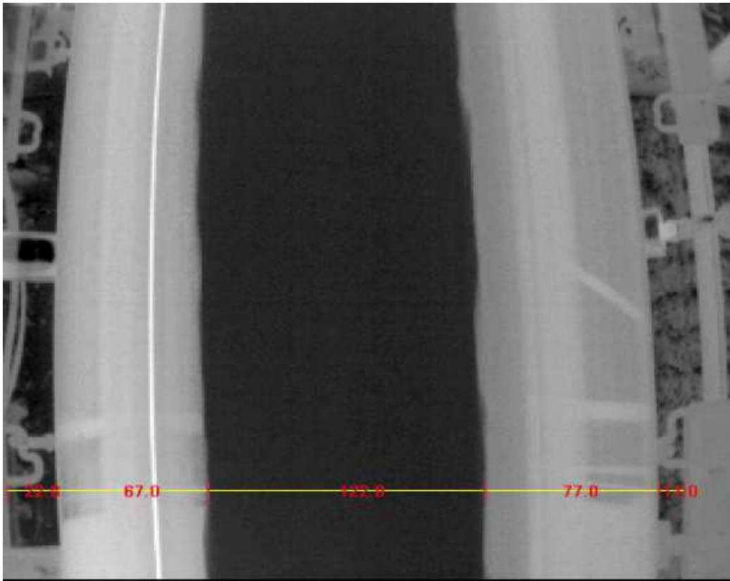
Abb. 4. Beispielhafte Infrarotaufnahme eines beladenen Förderbandes mit eingeblendeten geometrischen Markern (Aus [5])
