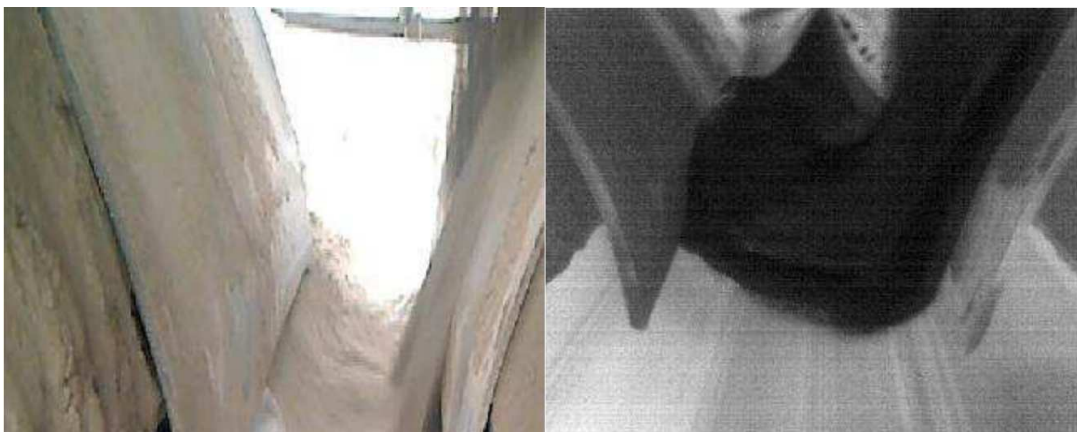
Abb. 3. Vergleich zwischen einem im sichtbarem Spektralbereich aufgenommenen Bild (links) und dem einer LWIR Infrarotkamera (rechts) (Aus [5])
