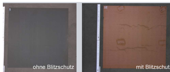
Abb. 1. Gefertigte CFK-Platten mit und ohne eine metallische Blitzschutzschicht.
