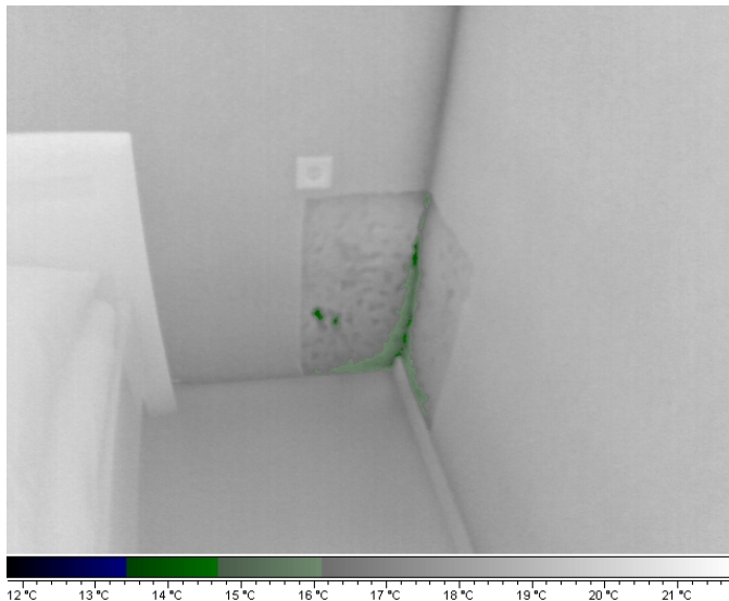
Abbildung 9. Stellt man einen Datenlogger auf, der über einige Wochen Außen- und Innentemperatur aufzeichnet und setzt die realen Messwerte in die Simulation ein, so zeigt sich, dass Schimmelbildung in diesem Beispiel nur sehr sporadisch auftritt.
