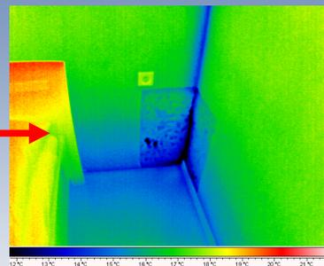
Ein unter real angetroffenen Bedingungen aufgenommenes Thermogramm wird über eine affine Abbildung in das Thermogramm umgerechnet, wie es unter Standardbedingungen entstehen würde. Das geht deshalb, weil die Wärmestromlinien und damit das Motiv nur von Material und Form abhängen, wobei der Kontrast nur von der Temperaturdifferenz abhängt.
