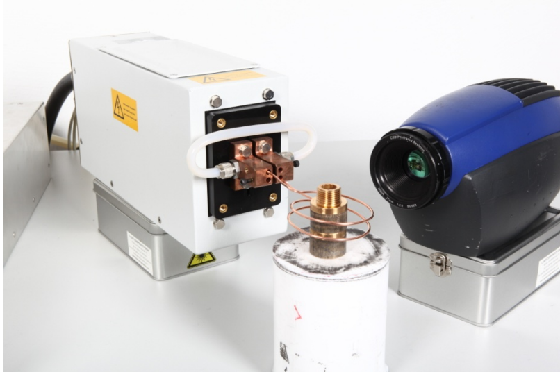
Abbildung 2. Laboraufbau mit Anpasser, Spule und Thermografiekamera.
