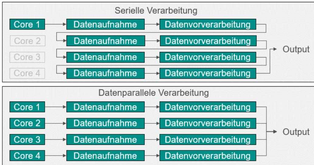
**Abb. 2.** Serielle und datenparallele Verarbeitung von Signalen. Bei der seriellen Verarbeitung wird der gesamte Arbeitsaufwand auf einen Kern beschränkt. Die datenparallele Verarbeitung ermöglicht die Verteilung des gesamten Arbeitsaufwands auf mehrere Kerne.
