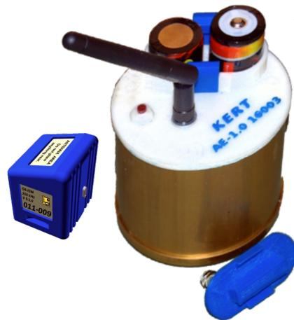
Abb. 1: Vergleich ISM-Sensor der 1. (rechts) und 5. Generation (links)
