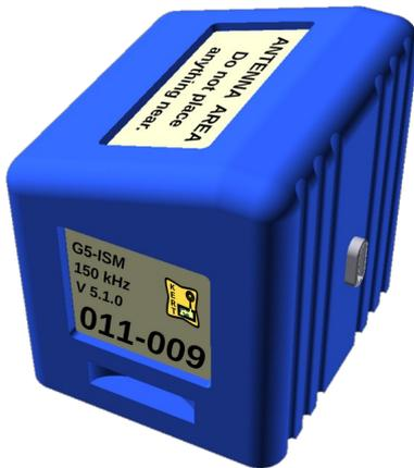
Abb. 7: ISM-Sensor 150 kHz
