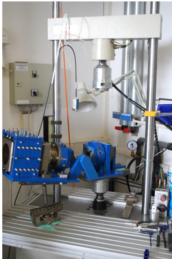
Abb. 2. Belastungseinheit nach Schmidt [5] mit Schenk Hydropuls Prüfmaschine PSA.
