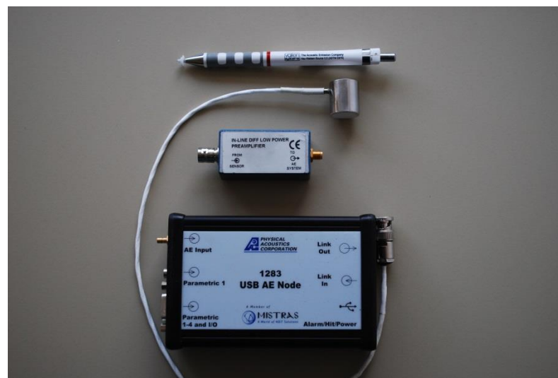
Abb. 3. Komponenten der SEA-Messkette und Hsu-Nielsen-Tester.
