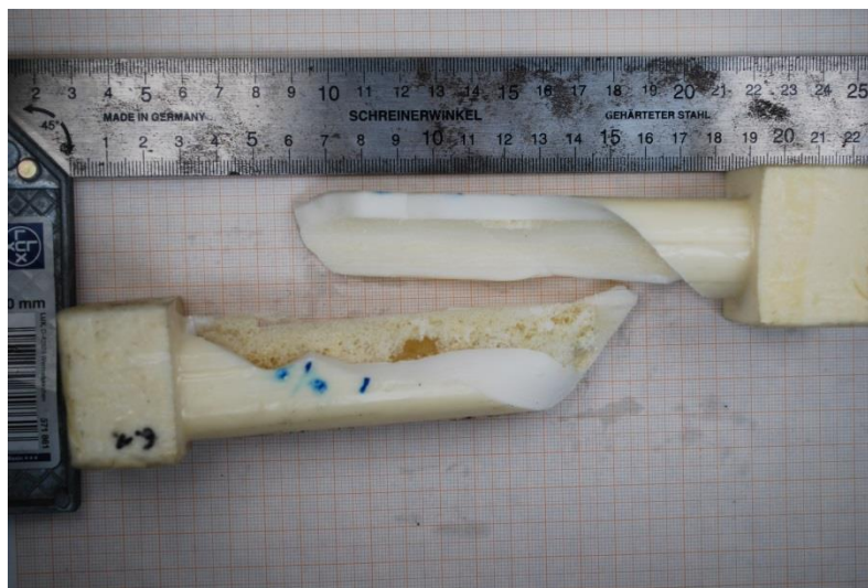
Abb. 5. Bruchstücke der belasteten Probe P_6.
