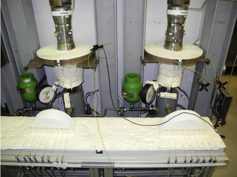
Abb. 5: Teststand für Kriechversuche an zwei P91-Rohrproben, links Probe 1, rechts Probe 2, ) Instrumentation pro Probe: zwei kapazitive Hochtemperatur-DMS (longitudinal, in Umfangsrichtung), zwei Thermoelemente zur Temperaturmessung, 8 senkrecht auf die Probenwandung aufgeschweißte, durch die Wärmeisolation geführte Wellenleiter bis hin zu Exponentialtrichtern mit Piezosensoren für die Schallemissionsanalyse (im Vordergrund)
