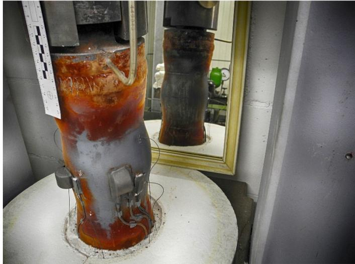
Abb. 8: Probe 1 nach Versuchsstopp am 24.10.2016 mit Ausbeulung und Querriss an der Rückseite, der zu einem Abfall des Probeninnendruckes führte
