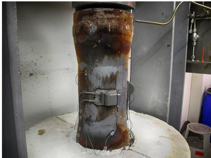
Abb. 9: Probe 2 ohne erkennbare makroskopische Schäden nach Versuchsstopp am 25.10.2016
