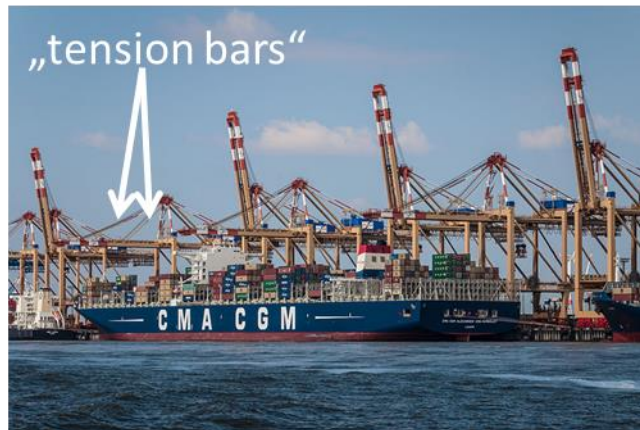
Abb. 2: Beispiel von Containerkränen im Betrieb. Die Kranausleger sind teilweise hochgeklappt. "tension bars" sind bei einem Kran durch die weißen Pfeile gekennzeichnet [10]
