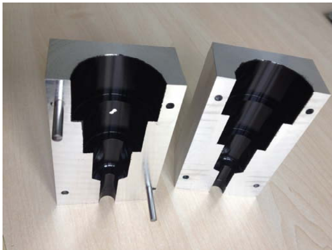
Phantom: Zweiteiliger Probekörper, innen schwarz glänzend lackiert, mit künstlicher Schlagstelle
