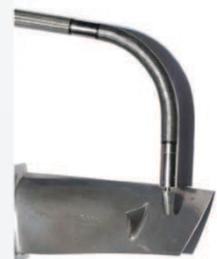
Flexibles Boroablending erlaubt den Zugang zu verschiedenen Positionen innerhalb des Triebwerkes
