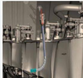
CAD Modell Rolls-Royce Triebwerk mit flexiblem Videoskop
