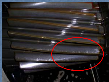
Durchläufer von hartem Material, Achtung: Lagerschaden
