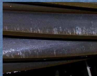
Durchläufer von hartem Material, Achtung: Lagerschaden
