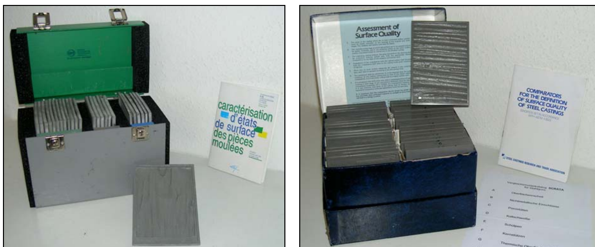
Abb. 1: Gussvergleichskataloge (links SCRATA und rechts BNIF)
