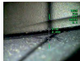
Bestimmung des Spaltes zwischen Turbinenschaufel und Gehäuse
