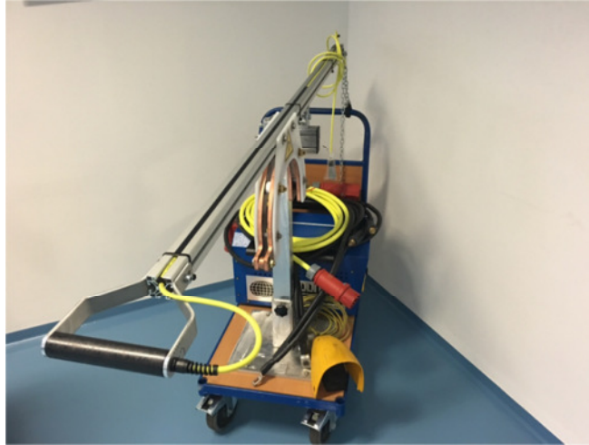
Abb. 9: Mobile Magnetpulverprüfanlage mit Halbkreissspule (Fa. Helling)
