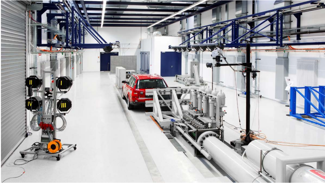
Abbildung 2: Forschungscrashanlage am Ernst-Mach-Institut in Efringen-Kirchen, Baden-Württemberg. Im Vordergrund ein hydraulisch-pneumatischer Aktuator, mit dem geregelte Impulsprofile von bis zu 70 g erzeugt werden können.
