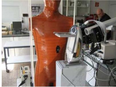
Bild 1: Messung an einem Aldersonphantom
